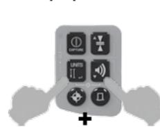
Нажмите одновременно кнопки «Единица измерения» и «Громкость», чтобы включить подсветку на 30 секунд и включения светодиодов с текущей настроенной яркостью. Последующие нажатия будут переключать настройки яркости светодиодов (высокая, низкая, выкл.). Текущая настройка яркости светодиодов будет храниться в памяти до выключения инструмента или замены батарей.
