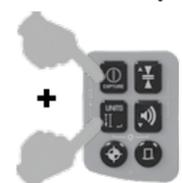
Нажмите и удерживайте кнопки «Питание» и «Единица измерения» в течение 1 секунды, чтобы переключить инструмент в режим лазерного дальномера.
